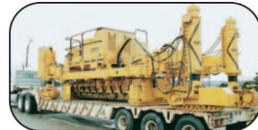
Трех- и четырехгусеничная модель GT-6300 разработаны для обеспечения быстрой и легкой мобильности во время работы и сведения к минимуму времени между разливками бетона.
