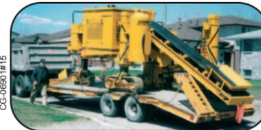
Загрузочный конвейер шириной 24 д. (610 мм), длиной 16 ф. (4.88 м) увеличивает производительность по загрузке бетона. Скорость конвейера варьируется до 320 ф./мин. (97.54 м/мин.). Также имеется шнек для подачи бетона длиной 16 ф. (4.88 м). Шнек диаметром 14 д. (356 мм) с новыми карбидными шнековыми бацмаками на скребке обеспечивает прочность и более длительный срок службы. Заново разработанный желоб прилегает к скребку плотнее для лучшего стока бетона. Скорость шнека варьируется до 90 об./мин.
