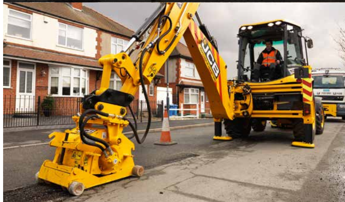
2. ПРОФИЛИРОВАНИЕ | Точное профилирование на глубину до 115 мм.
