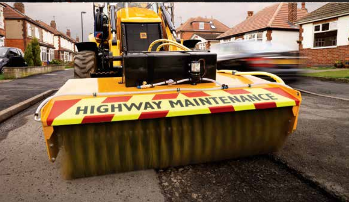
4. ОЧИСТКА | Подборная щетка собирает все частицы, грязь и воду.
