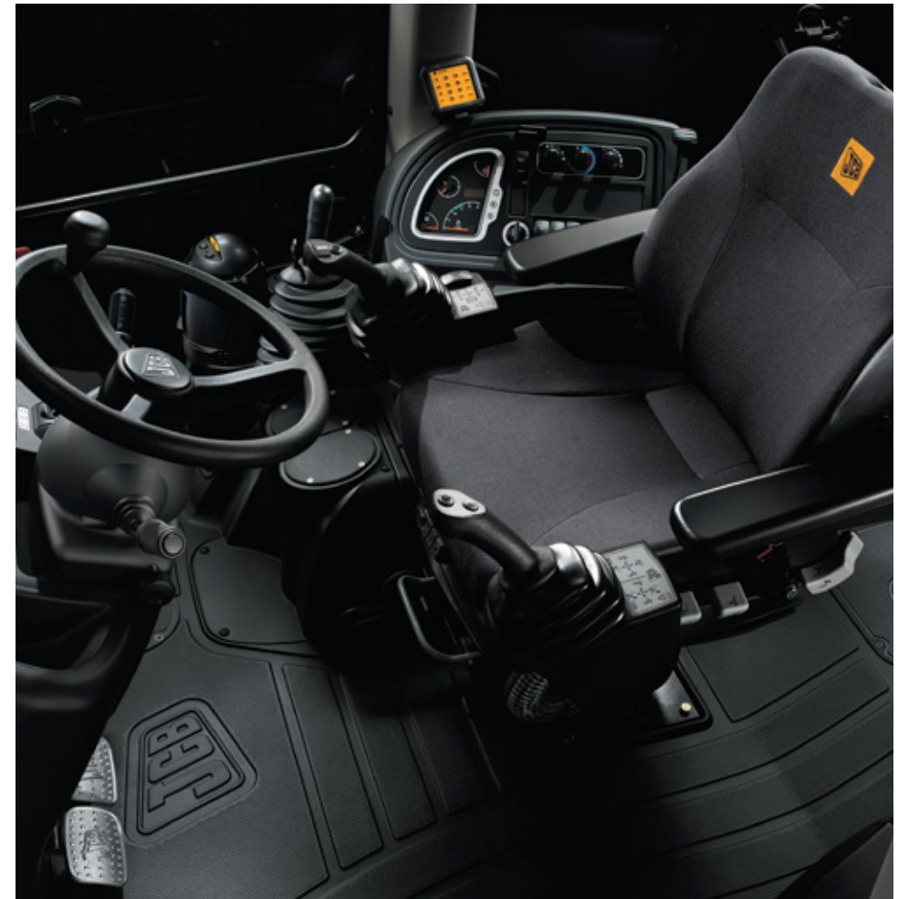
На правом джойстике предусмотрен переключатель для управления экскаваторным оборудованием, когда оператор сидит лицом по ходу движения, и погрузочным оборудованием, когда оператор сидит лицом против хода движения.
