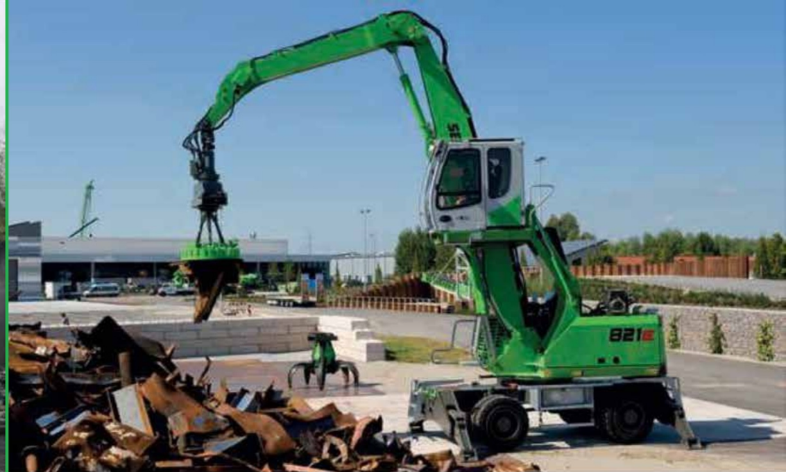
SENNEBOGEN Multitool – полностью гидравлическое устройство быстрой смены навесного оборудования
