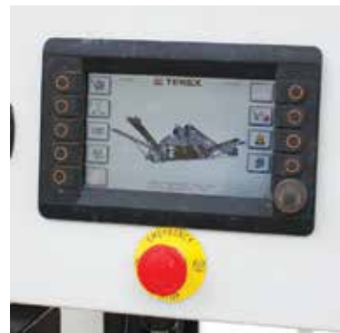
Панель управления локальной станцией
