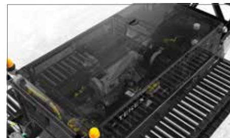
Полностью закрытый источник питания обеспечивает максимальную защиту, обеспечивая легкий доступ для ежедневного обслуживания
