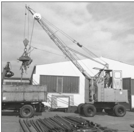
1962 год. Модель 5833 с канатным приводом и повышенным расположением кабины водителя
