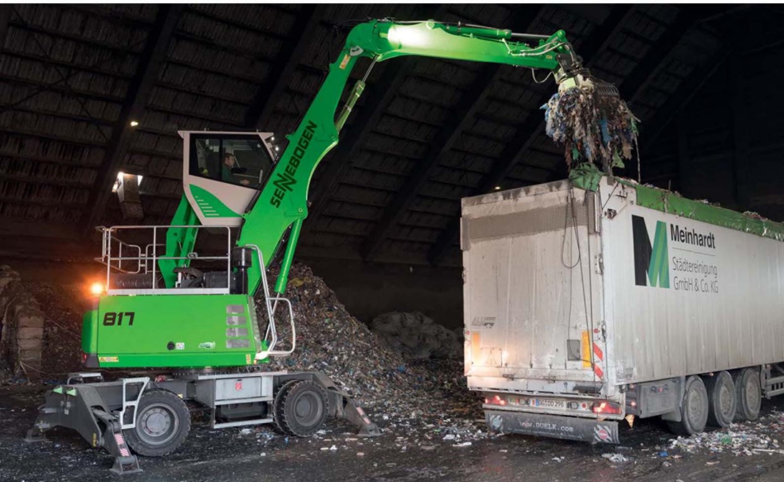
817 MRU — идеально подходит для работы в помещении благодаря компактным размерам, подъемной кабине и светодиодным прожекторам
