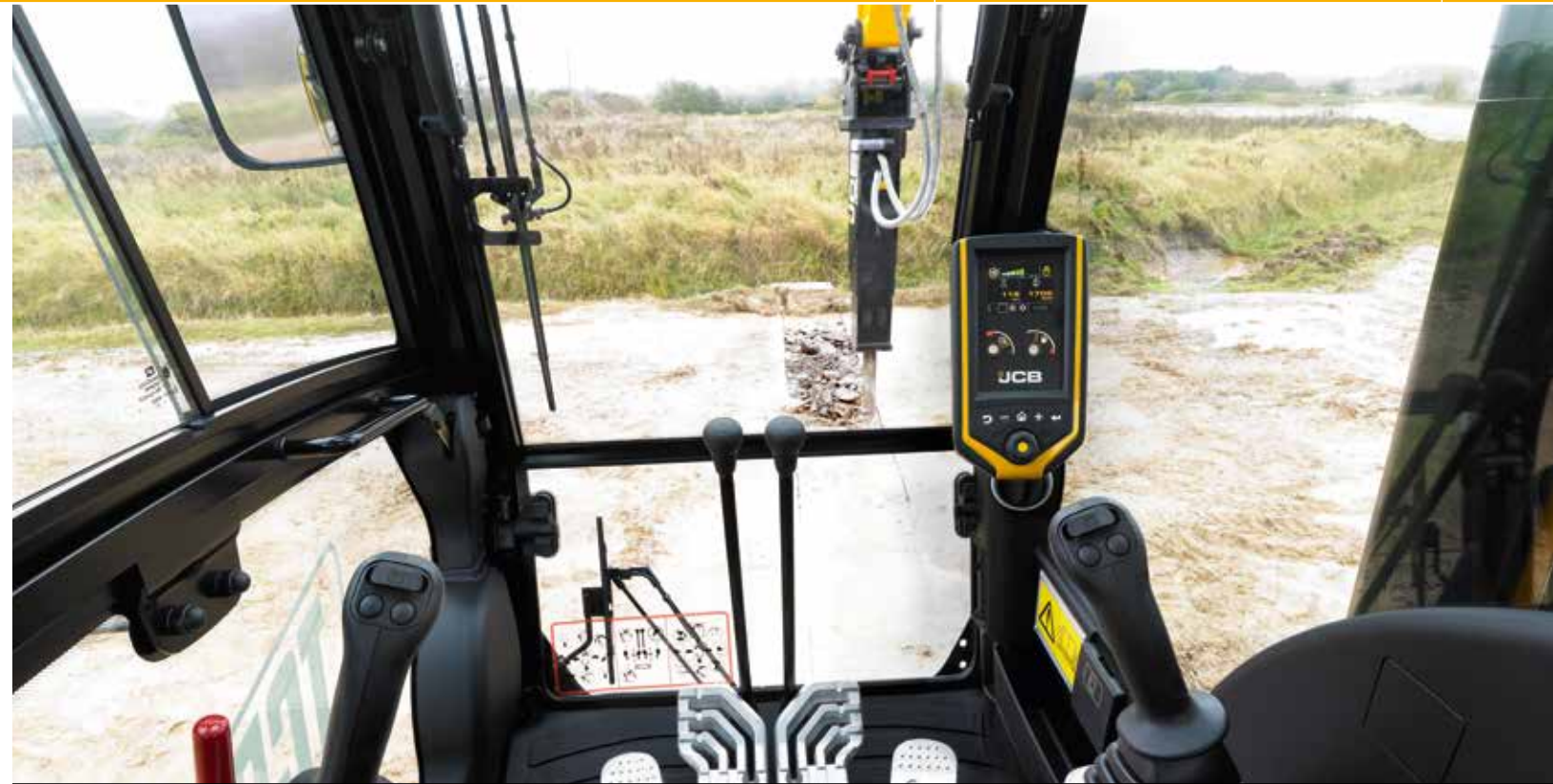
Разделение лобового стекла в соотношении 70/30 обеспечивает операторам машин JCB JS115/130/145 превосходную обзорность вперед.
