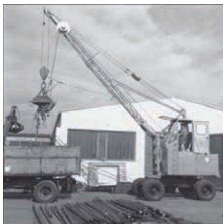
1962: Машина S833 с канатным приводом с кабиной оператора с фиксированным подъемом
