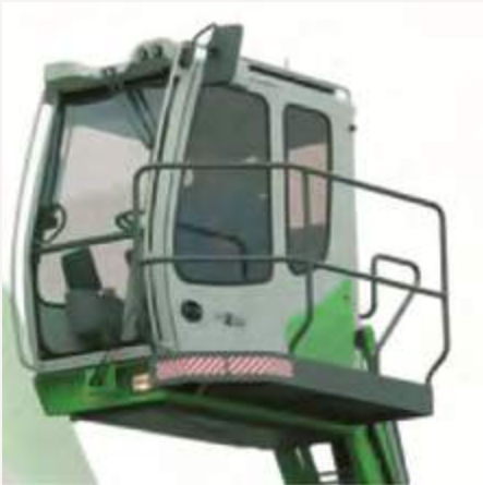
Большая подножка-трап с перилами с левой стороны кабины оператора для безопасного входа/выхода
