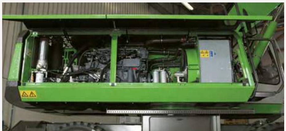
Удобный, безопасный доступ к двигателю и главному гидронасосу с уровня земли/ Доступ к топливному баку, централизованной системе смазки, электроблоку с уровня земли.
