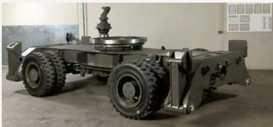
Цилиндрическая опора под поворотный круг интегрирована в раму шасси (не наварена сверху).
