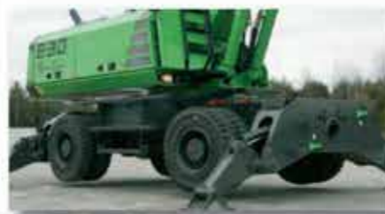
Ходовая часть - полностью модифицированная конструкция, оси HD разработаны с применением последних технологий undercarriage - completely redesigned construction, latest HD axle technology
