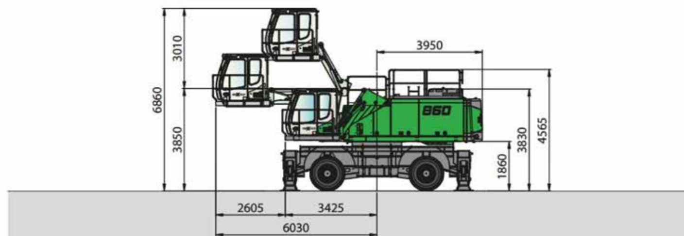
860 M RU с ходовой частью MP71 и кабиной Maxcab E300/276 с гидравлическим подъемником
