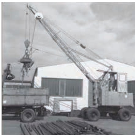
1962: Машина S833 с канатным приводом с кабиной оператора с фиксированным подъёмом
