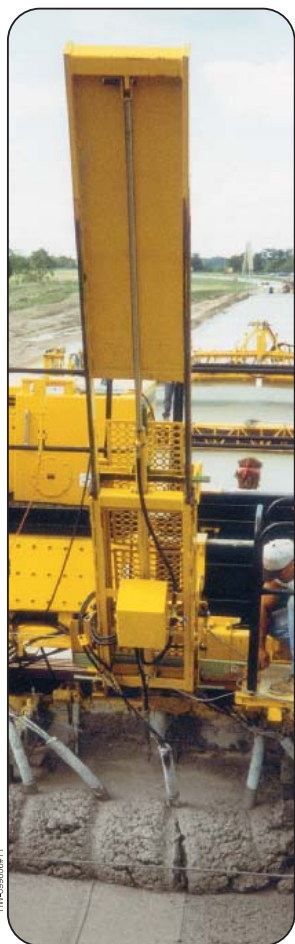
Гидравлическая система вибрационного внедрения боковых штырей.
