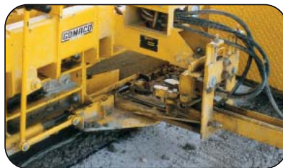
Гидравлическая система вибрационного внедрения боковых штырей.
