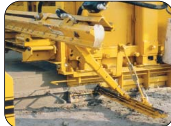
Механизм для бокового внедрения армирующих штырей.
