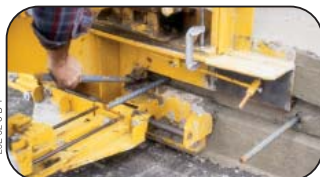
Гидравлическая система вибрационного внедрения боковых штырей.
