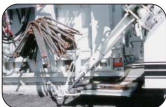
Механизм боковой укладки L-образных армирующих стержней с системой пневматического внедрения. Система пневматического внедрения используется и для установки большинства типов армирующих штырей.
