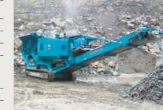
Силовая установка Tier 3/Stage 3A: CAT C13 ACERT 288кВт (385л.с.) Емкость топливного бака: 476 Л (125 US Gal)
