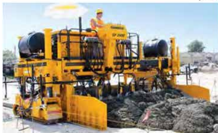
Консоль панели управления выдвигается при укладке и втягивается обратно для уменьшения габаритов при транспортировке.
